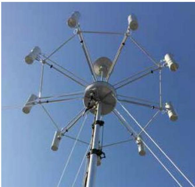
Антенная система со встроенным двухканальным центральным радиоприемным устройством (ЦРПУ), диапазон рабочих частот 200...8000МГц;
